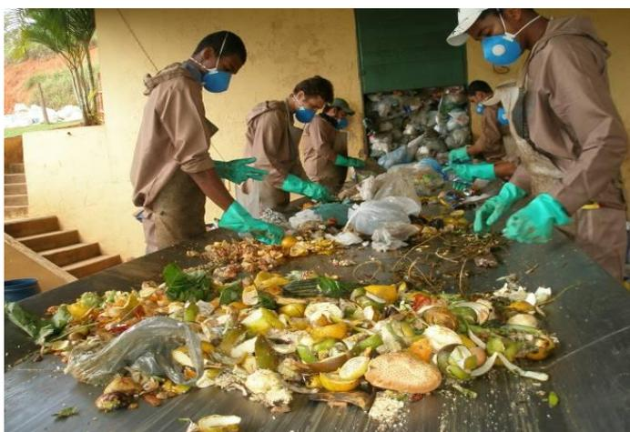
**Figura 32:** Área de triagem dos resíduos, observa-se mesa de triagem.
